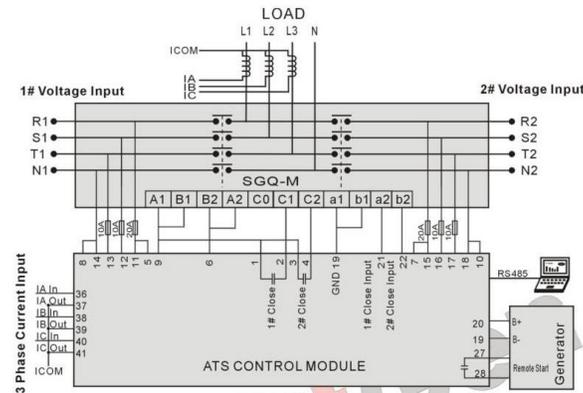
SGQ-M Wiring Diagram
